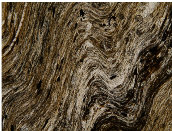
Fotomicrografia 18: Amostra HID-03 – Grafita-clorita-muscovita xisto, bastante deformado e crenulado. Aumento de 10X, lado maior: 1,5 mm; lado menor: 1,18 mm. Polarizadores paralelos.
